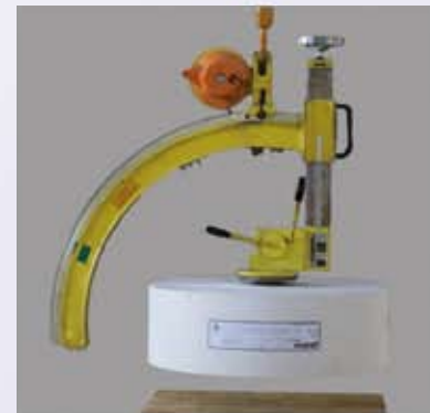
3. Anheben, selbsttätiges Spannen
