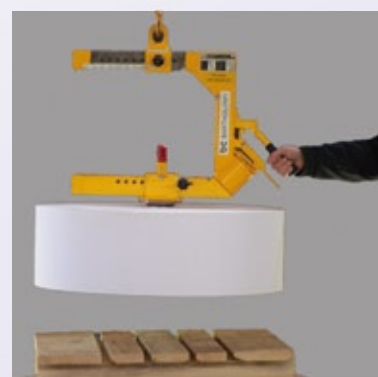
3. Anheben, selbsttätiges Spannen
